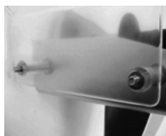
3. Placez les deux rondelles de blocage
