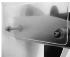
3. Umieść dwie podkładki na śrubach.
