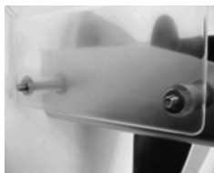
3. Inserire le due rondelle sui bulloni.
