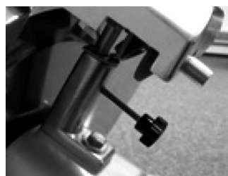
3. Затяните ручку, чтобы затачивающее устройство было неподвижным. Перед использованием устройства убедитесь, что затачивающее устройство надежно закреплено.
