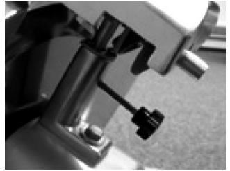
3. Ασφαλίστε το ακονιστήρι στη συσκευή σφίγγοντας το εξάρτημα συγκράτησης. Ελέγξτε για να βεβαιωθείτε ότι το ακονιστήρι είναι καλά στερεωμένο πριν τη χρήση του μηχανήματος.
