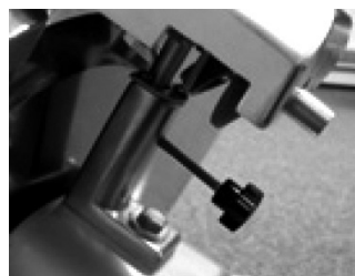
3. Fixez le dispositif d'aiguisage sur l'appareil en serrant la molette de fixation. Contrôlez que le dispositif d'aiguisage est bien fixé avant d'utiliser l'appareil.
