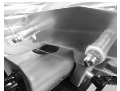
4. Die beiden Kapselmuttern anziehen.
